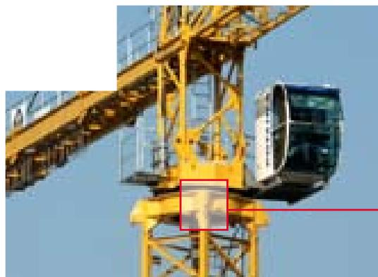
Die Verlaschung des Kabinenmastes erfolgt über 8 Achsen am Krankopf.
